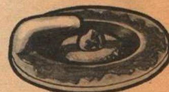
Mélange correct, mais bougie surchauffée, électrodes rongées, perles grises ou blanches.
